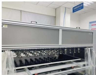
作为使用寿命长达25-30年的产品，光伏组件具备高可靠性，才能提供光伏系统全寿命周期的发电保证。为了验证组件全生命周期内抵御极端气候的能力，严格根据IEC测试标准，天合光能在光伏科学与技术国家重点实验室对210至尊670W组件和市场在售其他540W/535W组件同时进行了动态机械载荷（DML）极限加严测试。
