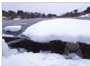
雪在组件表面尤其是底端大量堆积时，会造成不均匀压力。不均匀雪载测试专门评估光伏组件在遇到强降雪时，承受这种不均匀压力的能力，从而更有效规避将组件产品应用在多降雪地区，进而造成积雪压力引起的组件失效情况，如边框弯折或断裂、背玻不均匀性破裂、安装系统部分或完全解体等，为组件企业和业主提供最优解决方案。
